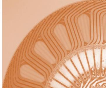
弊社のコアレスブラシ付きモータはパワーを必要とする、電動刈払機用に開発致しました。本モータは特殊装置を用いず、汎用機械で製作が可能です。独自技術によって銅メッキしたディスク基板を積層・接着し、電機子回路を構成しています。これを磁気回路(10極)と組み合わせたコアレスモータの構造となっています。
